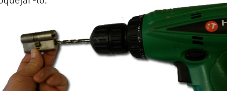
Exemple trepanació, es pot apreciar la palanca central que no hem de foradar
