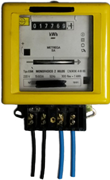
Model comptador clàssic. Fase d'entrada i sortida a l'esquerra i neutres a la dreta.
